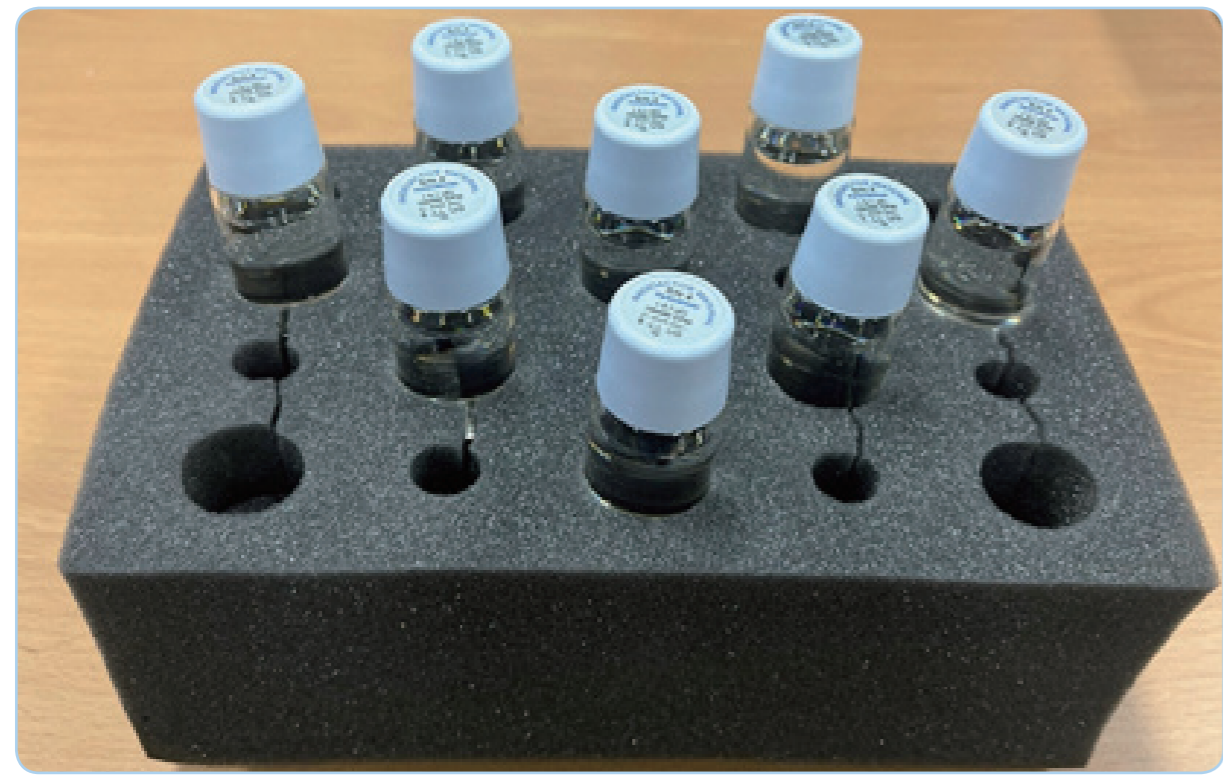
그림 2.37 삼중수소 Quenched Standard Source 사진
