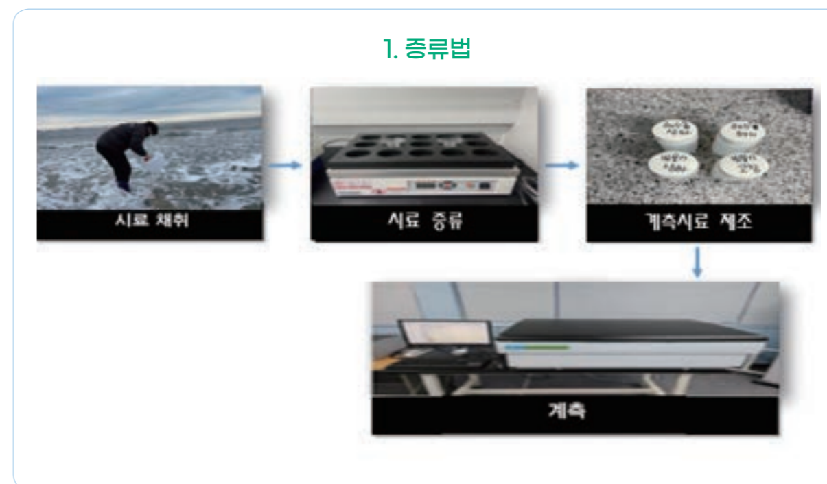
그림 2.14 삼중수소 분석을 위한 전처리절차(증류법)
